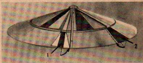
● Le « Brollycopter » de M. Olen Sipe, dont les essais, en modèle réduit, sont en cours, se compose de deux cônes pourvus de pales qui tournent en sens contraires.
