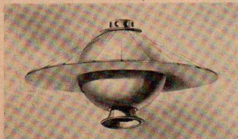
● Un ancêtre plus lointain encore : en 1889, les Français Faure et Graffigny songeaient à utiliser la pression du rayonnement solaire pour la propulsion dans l'espace de ce ballon sphérique qu'encercle une sorte de soucoupe.
